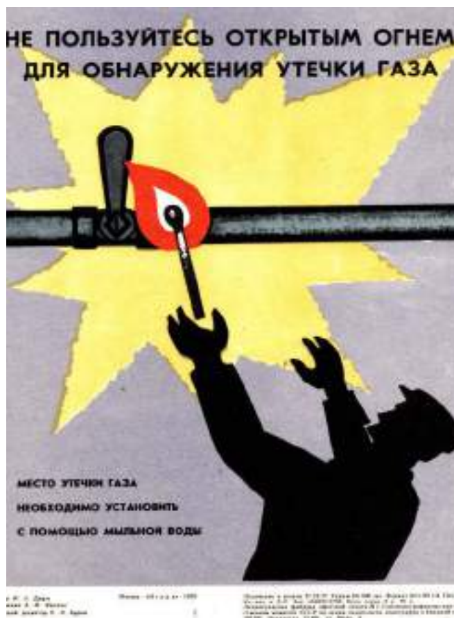
Не пользуйтесь открытым огнём для обнаружения газа: плакат / автор И.А. Друзь, худ. В.И. Фролов, вед. ред. Е.А. Буров. - М.: Недра, 1979. Плакат № 19.
